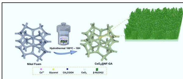
Hình 3.38. Sơ đồ mô phỏng quá trình tổng hợp mẫu \text{Ce@NF-GA}
